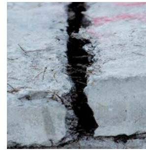
Fibra Metálica 54% de absorción de Energía después de un año
