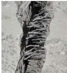
Fibra Sintética 98% de absorción de Energía después de un año
